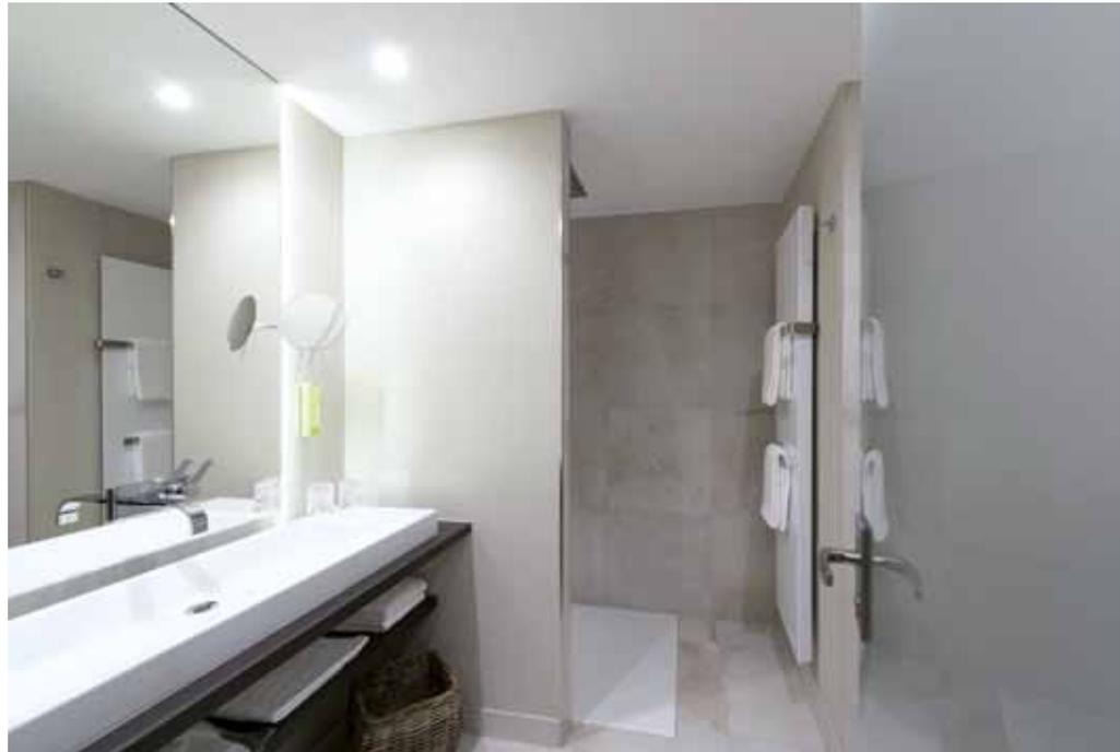
Fliesen und Fugen kamen wegen des Reinigungsaufwandes für den Duschbereich im Hofhotel Grothues-Potthoff nicht in Frage: Das Hotel setzt deshalb auf die bodenbündigen BetteFloor Duschflächen. Für erhöhte Standsicherheit der Hotelgäste beim Duschen sorgt die dauerhaft eingebrannte Antirutsch-Oberfläche.
